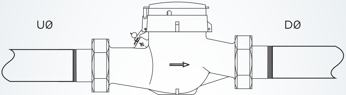
Nuestro contador Tritón no necesita tramos rectilíneos ni a la entrada ni a la salida.
